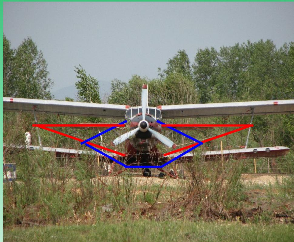
Установка на самолете. Момент основного диполя направлен вертикально вниз, момент компенсирующего диполя лежит в горизонтальной плоскости и направлен вдоль фюзеляжа.
