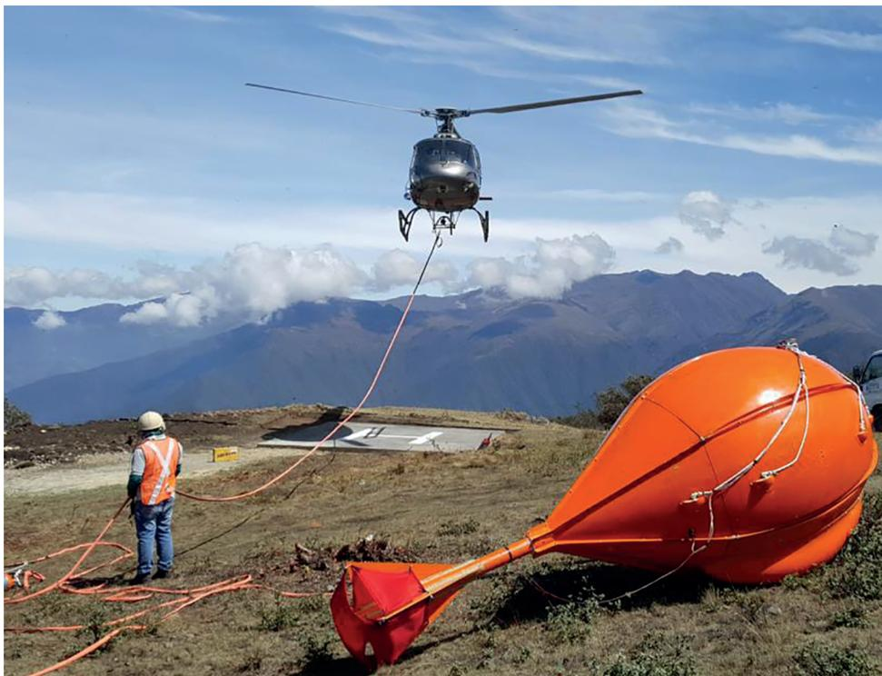
Рис. 3. Пассивная система MobileMT [Prihodko et al., 2020].
