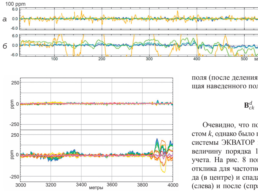
Рис. 7. Компенсация во временной области (вверху: параметры поля спада после компенсации, внизу: до компенсации, ppm)
