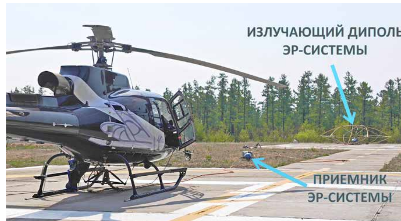
▲ Рис. 3. Комплексная аэрогеофизическая система ЭКВАТОР. Работы в Республике Бурятия, 2024 г.
