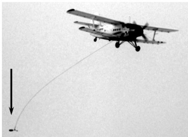
**Рис. 1.** Гондольное крепление датчика, Ан-2, ГНПП «Аэрогеофизика», 2004 г.
